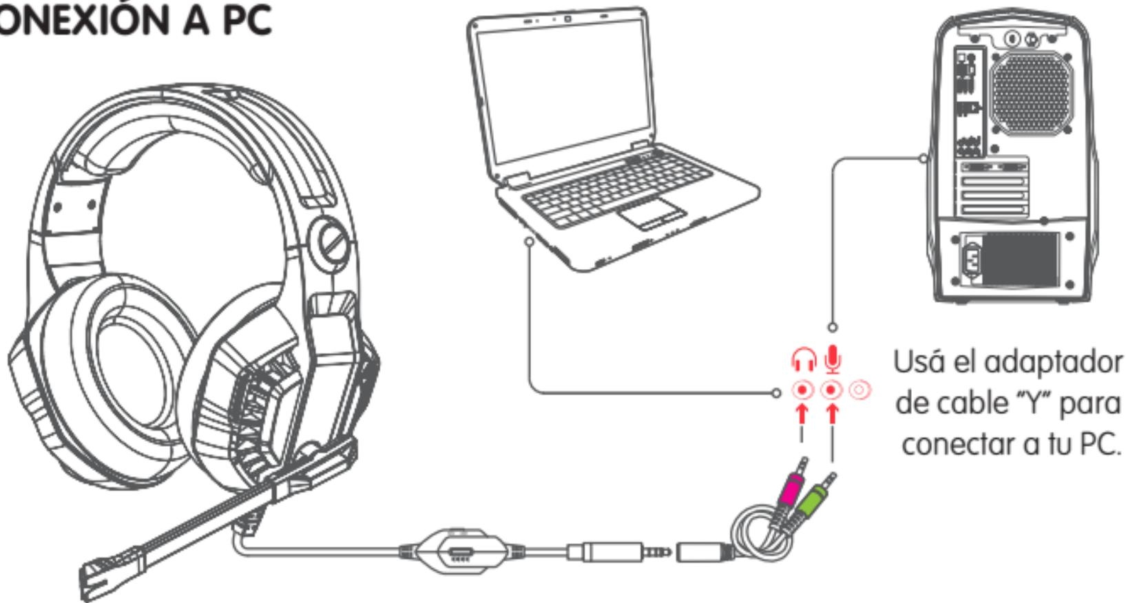
Usá el adaptador de cable "Y" para conectar a tu PC.
