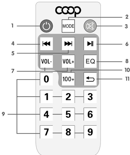
1. : Presioná brevemente para entrar en modo de espera; volvé a presionar brevemente para reanudar.
