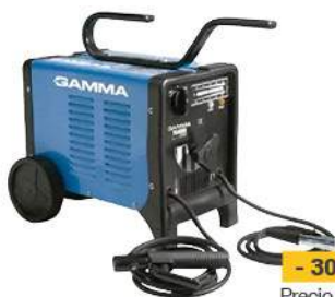
3708 SOLDADORA 220/380 vca - 50 hz. Monofásica. Diámetro electrodos: 1.6 - 4 mm. Protector térmico. 603517
