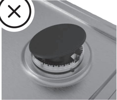
2- Al colocar la tapa sobre el cuerpo del mechero, asegurarse de que la misma se encuentre totalmente apoyada sobre el cuerpo sin que quede desalineada o cruzada sobre su base de apoyo (la tapa también tiene una determinada posición sobre el cuerpo), si no está correctamente colocada también puede provocar una llama incompleta o ineficiente.
